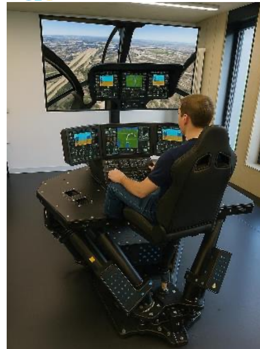
Plateforme de mouvement + cockpit hélicoptère + équipements H2C2
